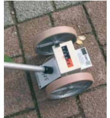
Das Längenmessgerät zeigt genau 269 m an.
